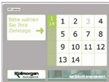
Bild 1: Das Touch Bedienterminal: Die eindeutige Aufteilung des Terminals stellt dem Nutzer die notwendigen Eingabefelder sowie die benötigten Informationen zur Verfügung.
